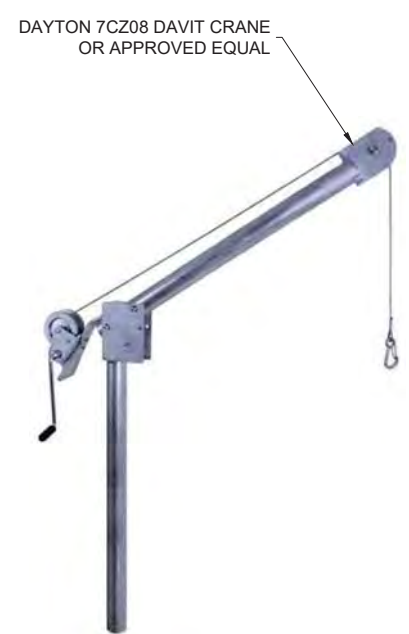
3 DAVIT CRANE DETAIL SCALE: N.T.S.
